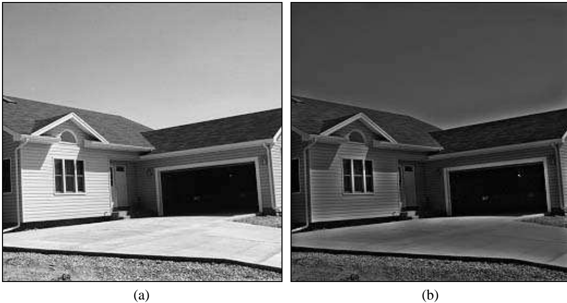
Figura 33 - Exemplo de filtragem homomórfica: (a) imagem original; (b) resultado da filtragem homomórfica com raio 8/128 , \gamma_H = 1,3 e \gamma_L = 0,7 .
