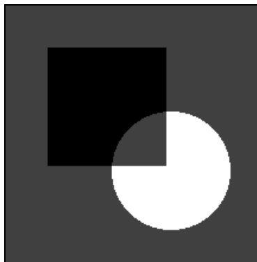
Figura 12 - Exemplo de divisão de imagens monocromáticas das figuras 9(a) e 9(b): X / Y (normalizado).
