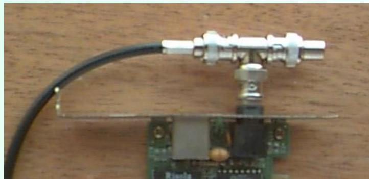
Cabo conectado a placa com terminador
