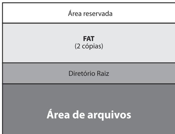
Figura 4.3 – Estrutura lógica de um HD
